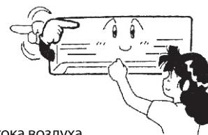
**МЕТОД ВТОРОЙ:** горизонтальная и вертикальная регулировка потока воздуха (у моделей оснащенным функцией 3D изменением потока воздуха)
